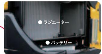
工具なしで開き、バッテリーチェック、ラジエーターの清掃が容易。
