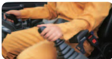
レバー操作時の腕の負担を軽減。疲れにくく、精度が求められる微操作も手元でラクに行えます。
