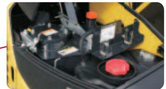
燃料や作動油の給油、ラジエーター裏側の清掃、グリスガン設置が可能。
