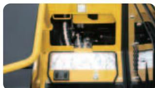
点検しやすい大きな点検窓を設置。
